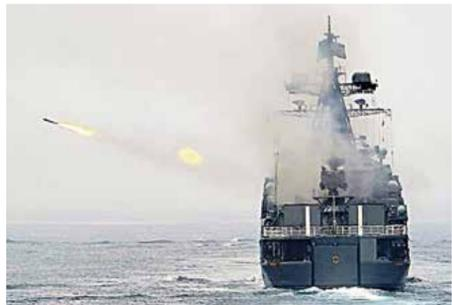
Боевая часть ракеты успешно поразила подводную цель. Для запуска противолодочных ракет используются универсальные пусковые установки, которые позволяют также применять крылатые ракеты «Оникс» и «Калибр».
